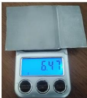
شکل ۹. نمونه‌ای از آند آلومینیوم در حال توزین
