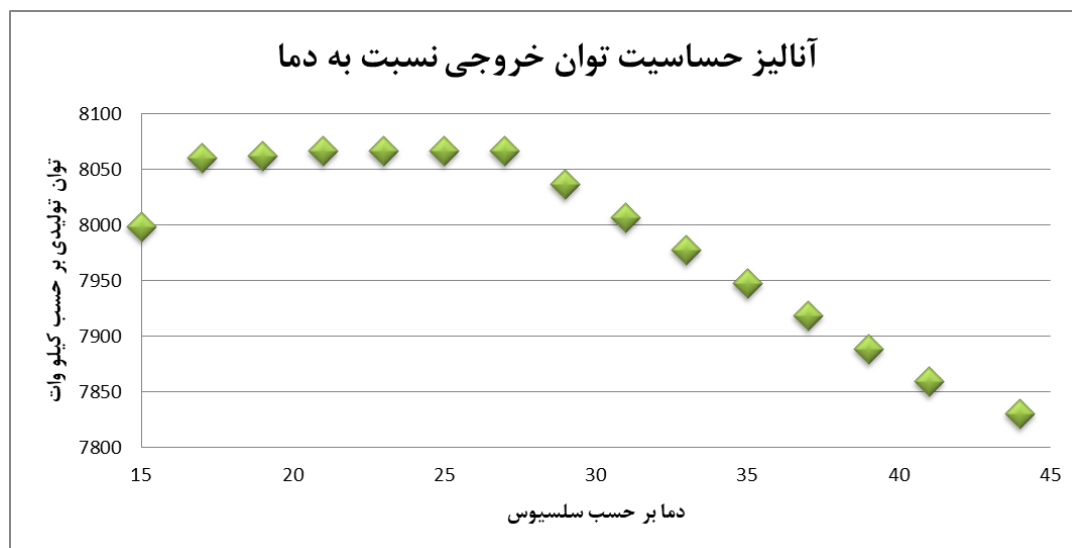
شکل ۱۰. تحلیل حساسیت توان خروجی پانل‌های نصب‌شده نسبت به تغییرات دمایی
