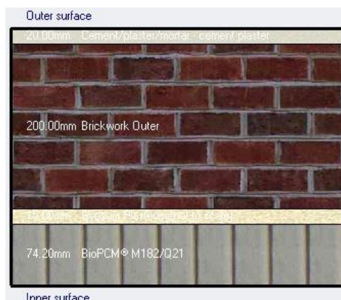
شکل ۷. سطح مقطع و لایه‌بندی مصالح دیوار خارجی با وجود تغییرفازدهنده
