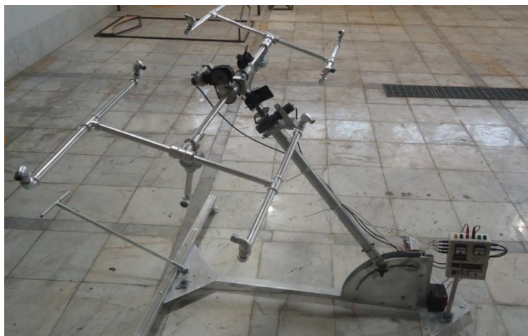
شکل ۱. شماتیک سازه ردیاب خورشیدی طراحی شده برای نصب دو پنل
