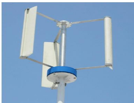
شکل ۱. توربین بادی محور عمودی نوع اچ، سه پره مستقیم [۶]
