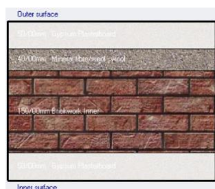
شکل ۱۵. دیوار با لایه‌های گچ، پشم معدنی، آجر و گچ
