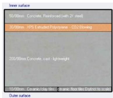
شکل ۱۴. مقاومت حرارتی کف
