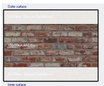
شکل ۱۶. دیوار با لایه‌های گچ، بلوک سبک هوادار
