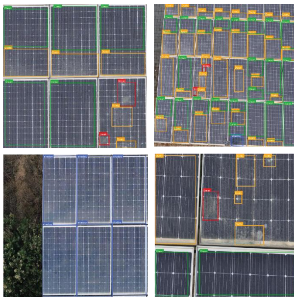
شکل ۲. نمونه‌هایی از مجموعه داده پنل‌های خورشیدی به همراه جعبه‌های محدودکننده مربوط به کلاس‌های شکستگی، ناحیه سالم، گردوغبار و سایه
