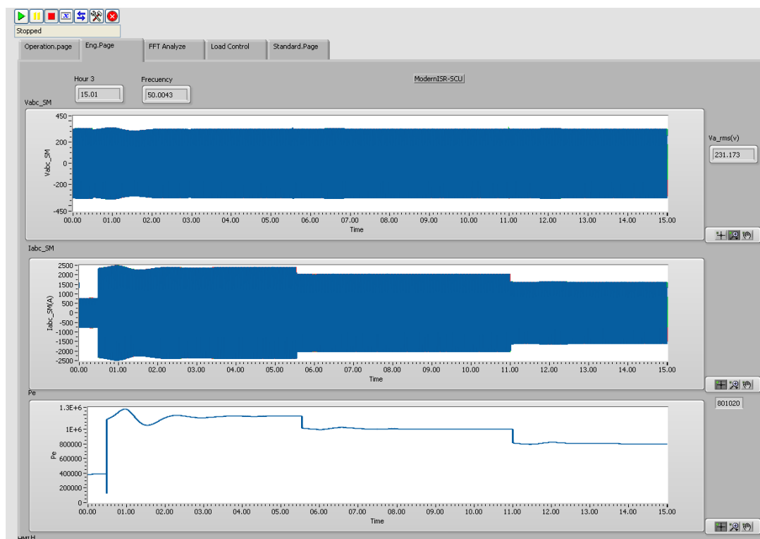
شکل ۶. شکل موج‌های ولتاژ و جریان و تغییرات توان ژنراتور در سناریوی ۱
