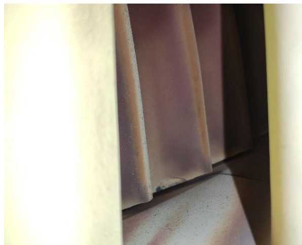
شکل ۵. نمایی از وجود رسوب در مسیر خنک‌کاری پره‌های متحرک توربین
