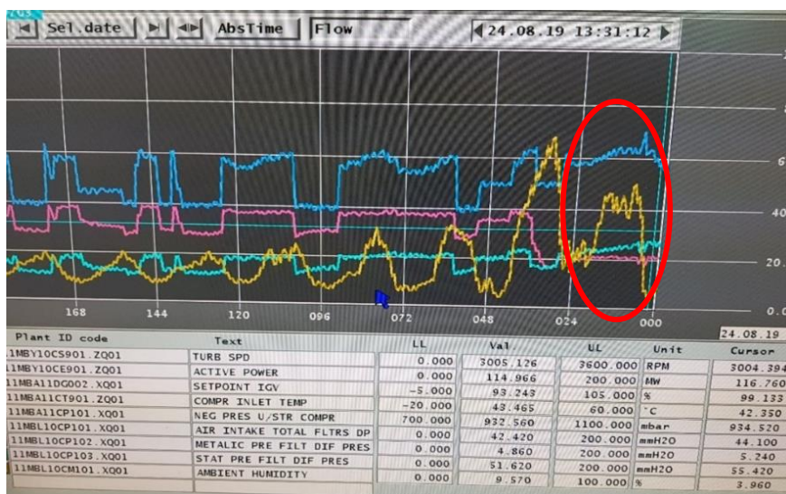
شکل ۲. ترند DCS نیروگاه و افزایش رطوبت و هم‌زمان کاهش اختلاف فشار فیلترهای ورودی
