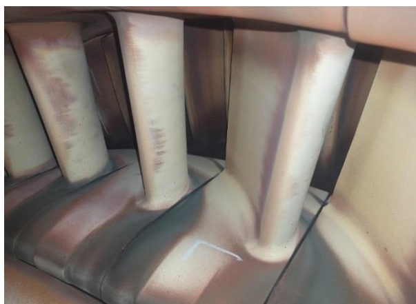
شکل ۷. سایش در پره‌های ورودی توربین گاز و کاهش ضخامت پوشش و یا حذف آن
