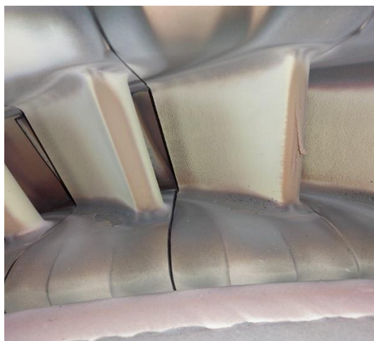
شکل ۴. نمایی از اثرات سایش و کنده شدن پوشش پرهٔ ردیف اول توربین
