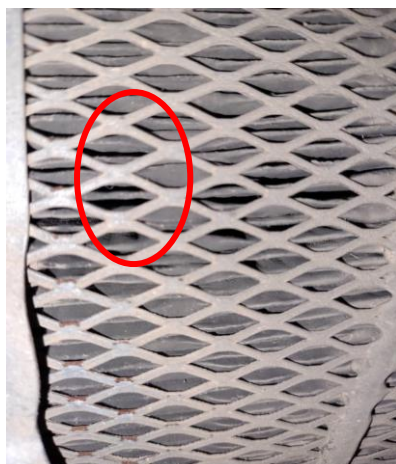
شکل ۳. نمایی از اثرات تخریب کاغذ فیلترهای ورودی
